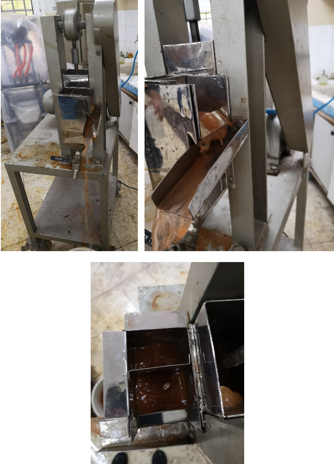
Şekil 3. Testlerde kullanılan laboratuvar ölçekli Jig cihazı.
